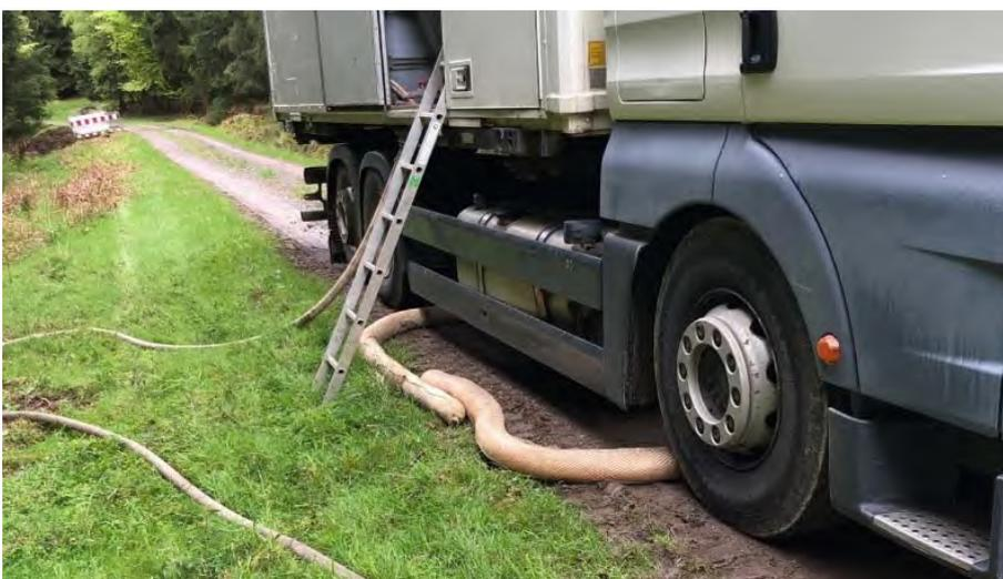
Abbildung 6: Empfohlene Maßnahme: Vorsorgliche Auslage von Sorbschlängeln unter Tanks, z.B. von Baufahrzeugen, wenn sie länger stehen.
