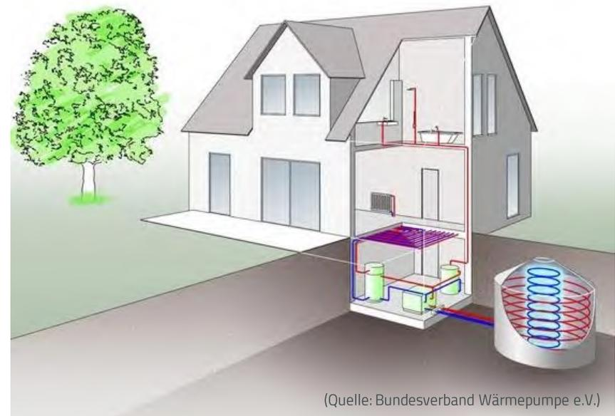
**Fazit:** Regeneration des Eisspeichers im Sommer erforderlich (Wärme- und Kältebedarf notwendig)
